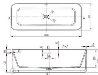
Vasca Freestanding monolite in **solid surface colore bianco matt**. Completa di troppo pieno, piletta di scarico click clack, sifone e tubo di scarico  $\varnothing$  32 mm.
