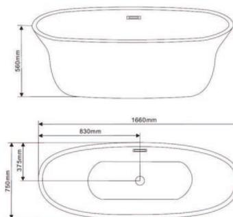
Vasca Freestanding in puro acrilico colore bianco lucido. Completa di troppo pieno, piletta di scarico click clack, sifone e tubo di scarico  $\varnothing$  32 mm. Supportata da struttura in acciaio inox con piedi regolabili "da cm. 0 a cm. 4 h". La vasca è realizzata in due gusci saldati, i quali conferiscono alla stessa un aspetto monolitico come se fosse un unico pezzo sia al tatto che alla vista.
