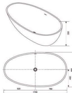
Vasca Freestanding in puro acrilico colore bianco lucido. Completa di troppo pieno, piletta di scarico click clack, sifone e tubo di scarico ø 32 mm. Supportata da struttura in acciaio inox con piedi regolabili "da cm. 0 a cm. 4 h". La vasca è realizzata in due gusci saldati, i quali conferiscono alla stessa un aspetto monolitico come se fosse un unico pezzo sia al tatto che alla vista.
