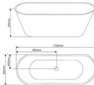
Vasca Freestanding in puro acrilico colore bianco lucido. Completa di troppo pieno, pialetta di scarico click clack, sifone e tubo di scarico ø 32 mm. Supportata da struttura in acciaio inox con piedi regolabili "da cm. 0 a cm. 4 h". La vasca è realizzata in due gusci saldati, i quali conferiscono alla stessa un aspetto monolitico come se fosse un unico pezzo sia al tatto che alla vista.
