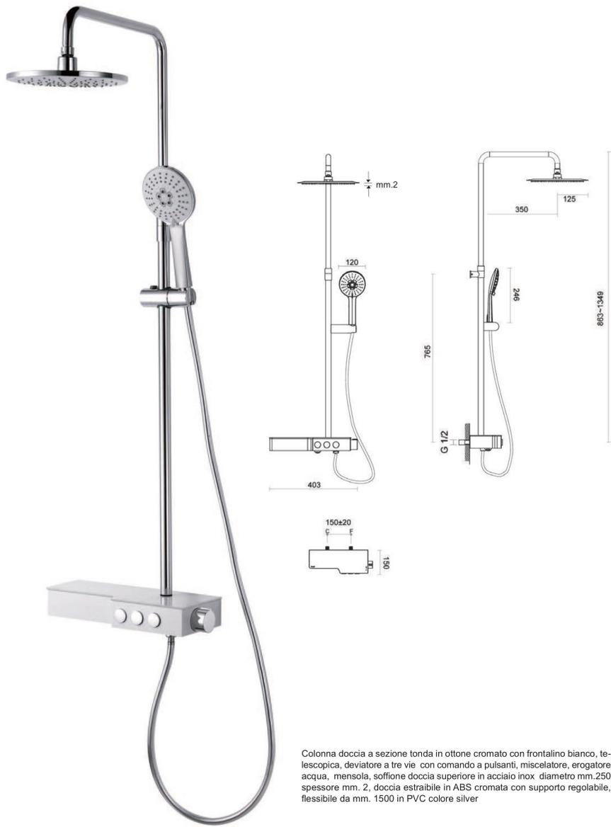
Colonna doccia a sezione tonda in ottone cromato con frontalino bianco, telescopica, deviatore a tre vie con comando a pulsanti, miscelatore, erogatore acqua, mensola, soffione doccia superiore in acciaio inox diametro mm.250 spessore mm. 2, doccia estraibile in ABS cromata con supporto regolabile, flessibile da mm. 1500 in PVC colore silver
