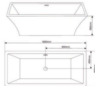
Vasca Freestanding in puro acrilico colore bianco lucido. Completa di troppo pieno, piletta di scarico click clack, sifone e tubo di scarico  $\varnothing$  32 mm. Supportata da struttura in acciaio inox con piedi regolabili "da cm. 0 a cm. 4 h". La vasca è realizzata in due gusci saldati, i quali conferiscono alla stessa un aspetto monolitico come se fosse un unico pezzo sia al tatto che alla vista.
