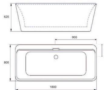
Vasca Freestanding in puro acrilico colore bianco lucido. Completa di troppo pieno, piletta di scarico click clack, sifone e tubo di scarico  $\varnothing$  32 mm. Supportata da struttura in acciaio inox con piedi regolabili "da cm. 0 a cm. 4 h". La vasca è realizzata in due gusci saldati, i quali conferiscono alla stessa un aspetto monolitico come se fosse un unico pezzo sia al tatto che alla vista.
