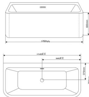
Vasca Freestanding in puro acrilico colore bianco lucido. Completa di troppo pieno, piletta di scarico click clack, sifone e tubo di scarico  $\varnothing$  32 mm. Supportata da struttura in acciaio inox con piedi regolabili "da cm. 0 a cm. 4 h". La vasca è realizzata in due gusci saldati, i quali conferiscono alla stessa un aspetto monolitico come se fosse un unico pezzo sia al tatto che alla vista. Adatta per installazione DX/SX e centro parete
