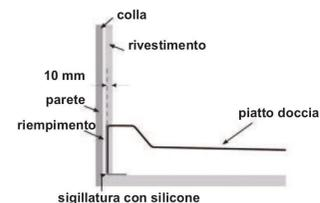
Non incassare il piatto doccia sotto il rivestimento ceramico per più di 10 mm. in entrambi i lati delle pareti, in questo modo si eviteranno problemi di posizionamento e regolazione del box doccia.
