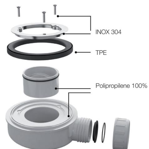
**Montaggio della piletta di scarico:**
