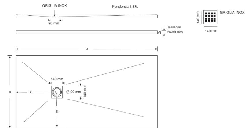
I piatti doccia della Collezione "PIETRALUX" sono realizzati in "Marmo resina", un materiale composito ottenuto dalla miscela di polvere di marmo con resine a base di poliestere. In superficie il piatto doccia è ricoperto da uno strato di resina poliestere "Gel Coat", la sua particolare caratteristica tecnica conferisce al prodotto, impermeabilità, resistenza ai graffi, all'usura, ai raggi UV, non muta di colore nel tempo.
